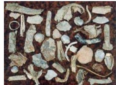
Установка по очистке глины ZAR является ответным решением для очистки пластичных масс от органических и неорганических инородных включений. Применение ситовых кожухов с отверстиями размером 3 мм позволяет производить эффективное отделение обрабатываемой массы от таких включений и примесей, как камней, кварца, колчедана, гальки, дерева, корней растений, частиц металла и пластика, и их удаление из машины без прерывания процесса очистки.
